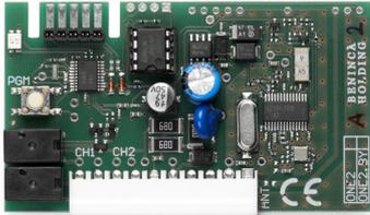
**Récepteur à enclenchement** pour des centrales de commande dotées de connecteur rapide molex.
