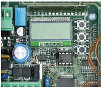
**Récepteur intégré**, dans la centrale de commande avec programmation à l'aide d'un écran LCD. Sur ce type de centrales, il y a toujours un menu radio par l'intermédiaire duquel il est possible d'effectuer toutes les opérations de programmation du récepteur intégré. Le menu radio permet également la gestion des fonctions avancées spécifiques à chaque appareil.
