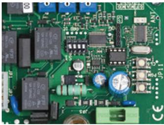
**Récepteur intégré** dans la centrale de commande avec programmation à l'aide de boutons et de trimmer/dip-switches.
